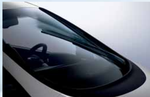
Le capteur de pluie (de série sur version Stylance) réagit à la moindre goutte.
