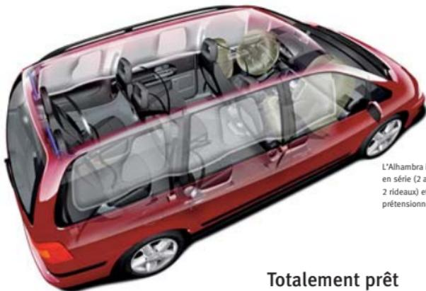
L'Alhambra intègre 6 airbags en série (2 avant, 2 latéraux, 2 rideaux) et des ceintures avec prétensionneurs à l'avant.
